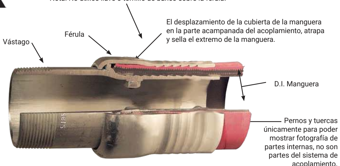
Sección transversal de un ensamble Holedall de suajado externo.
